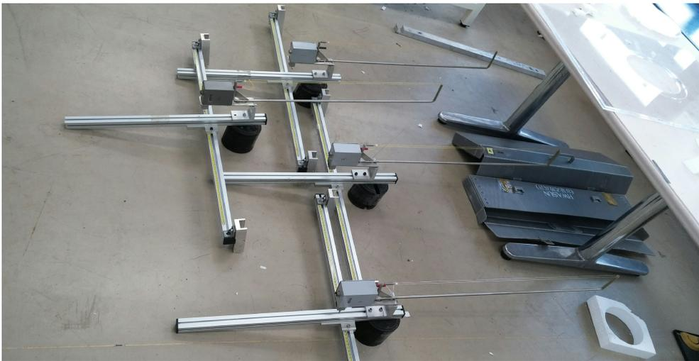
Fig. 8 Wave probe
