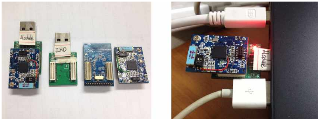
[그림 39] 통신모듈과 USB Interface 모듈 (a) 통신 모듈 구성 (b) USB 시리얼을 통한 프로그램 포팅
