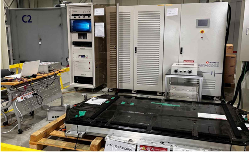
그림 5 코나 전기차 배터리 탈착 평가 모습 <민테크㈜ 전자신문 2022>
