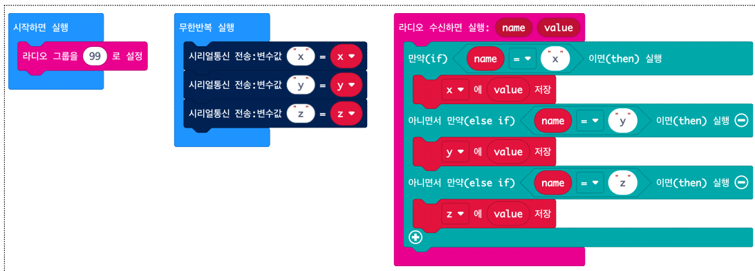
[그림 II-13] 라디오 전송 기능을 활용한 데이터 수신 및 시리얼 통신
